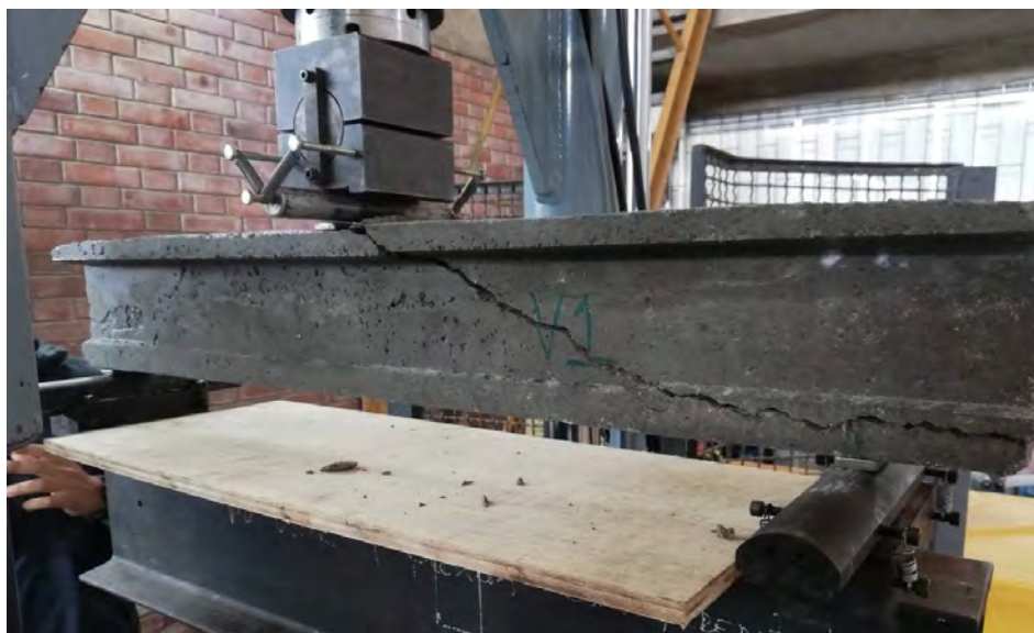
Figura 6.7. Trayectoria de la grieta por tracción diagonal
