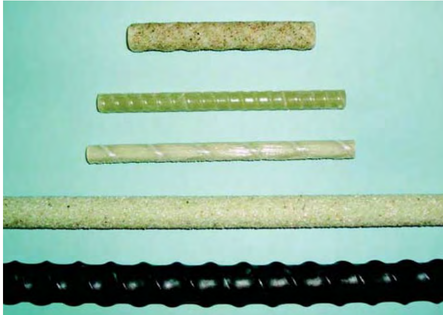
Figura 2.7. Ejemplos de barras de refuerzo de FRP (ACI, 2015)
