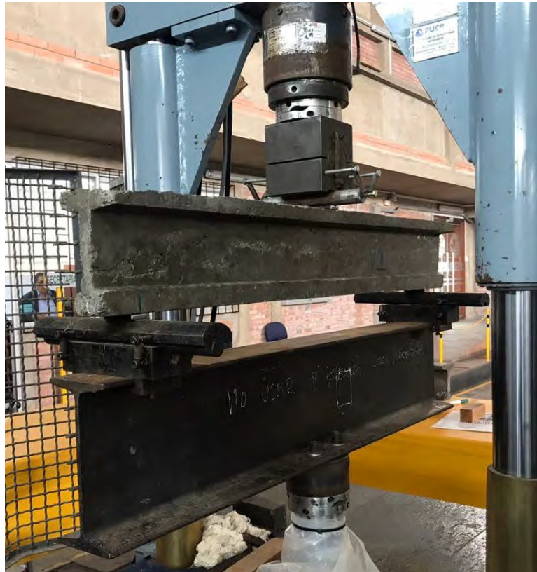
Figura 5.7 Disposición del ensayo experimental en la viga
