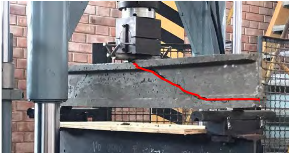
Figura 6.2. Grieta de falla de la viga V – 01
