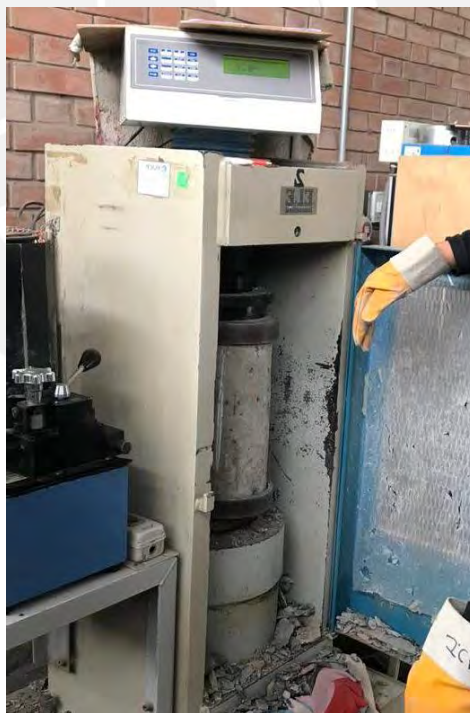
Figura 5.4. Ensayo de compresión simple en las probetas de concreto
