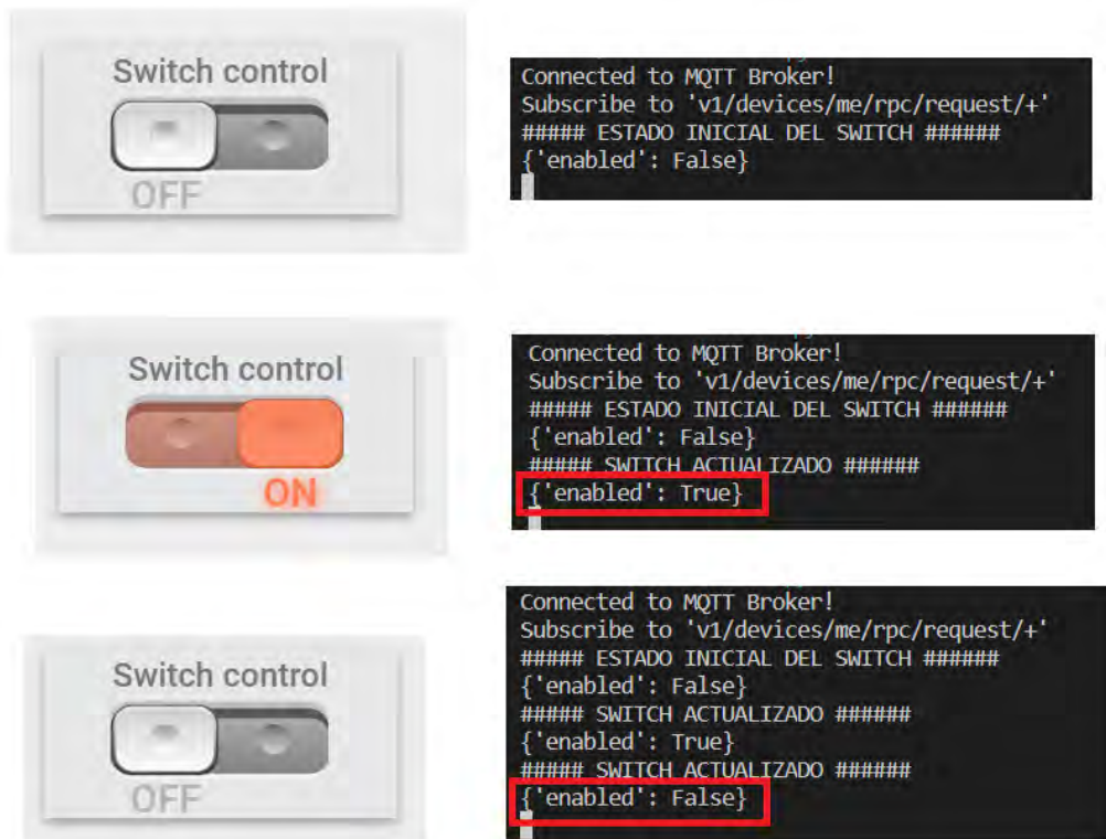
Figura 3.9. Ejemplo de control remoto de un switch con un switch control Fuente: elaboración propia
