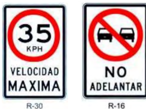
Figura 25. Señalizaciones restrictivas de tránsito. Fuente: (MTC, 2000)
