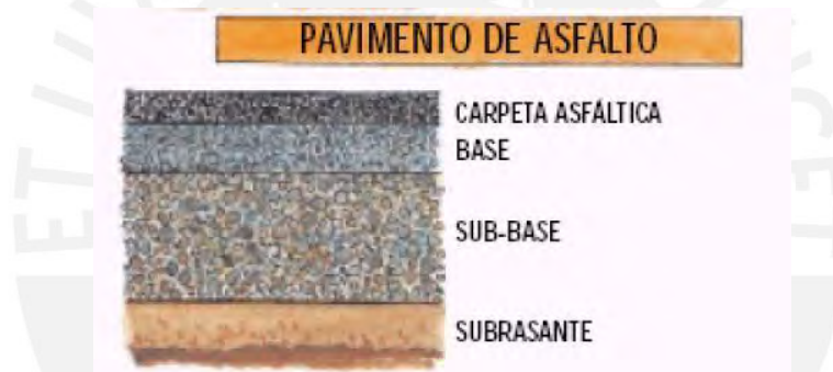
Figura 17. Estructura del pavimento flexible Fuente: Olcese 2021
