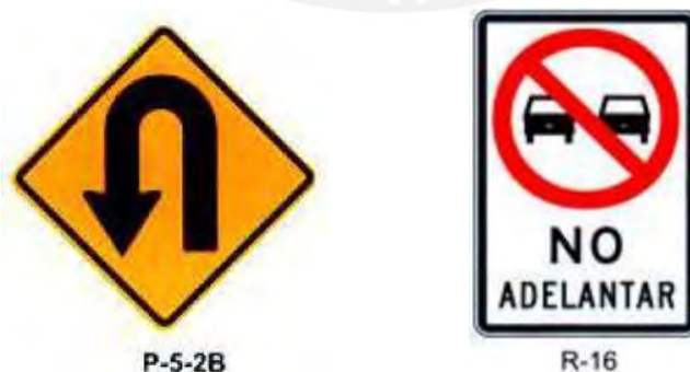
Figura 46. Señalización preventiva “P-5-2B” y “R-16”. Fuente: (MTC, 2000)
