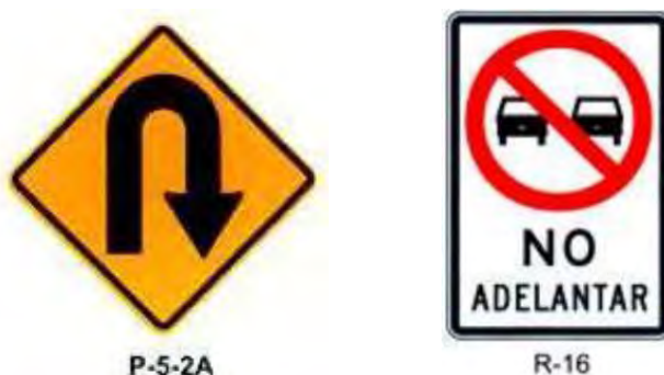
Figura 29. Señal preventiva P-5-2A y reglamentaria R-16. Fuente: (MTC, 2000)
