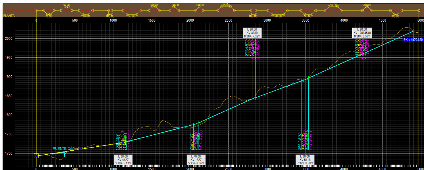
Figura 50. Rasante del alineamiento vertical alternativa 3. Fuente: Istram
