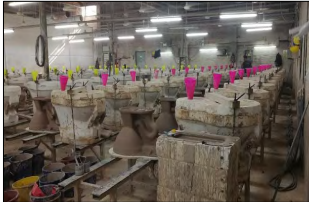
Figura 16. Área de Colaje
