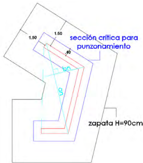
Figura N° 78. Propuesta de cimentación para la placa PL03
