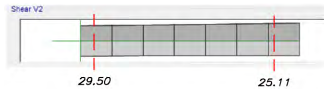
Figura N° 36. Cortantes debido a combinaciones con factor de amplificación sísmica igual a 2.5
