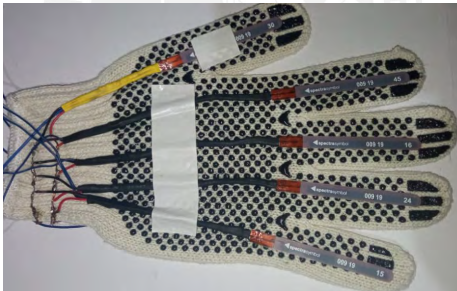
Figura 5.10. Vista inferior del guante, con los sensores flex
