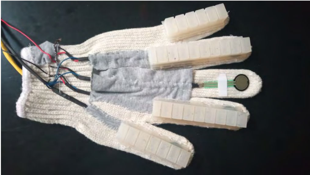
Figura 5.11. Capa de tela sobre los sensores y lugar de los actuadores en el guante
