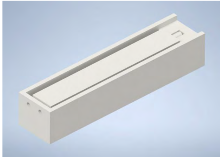
Figura 5.5. Molde del actuador
