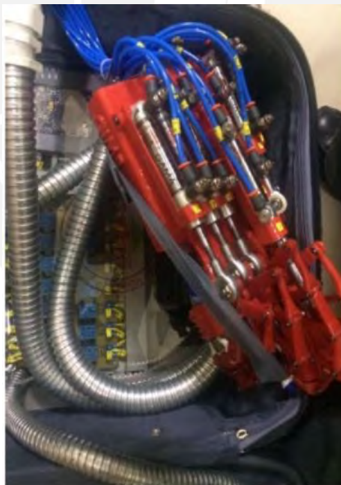
Figura 1.9. Arreglo de los actuadores del rehabilitador (Mosquera, Benavides, Ojeda, & Ortiz, 2018)
