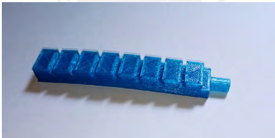
Figura 5.4. Actuador impreso en TPU
