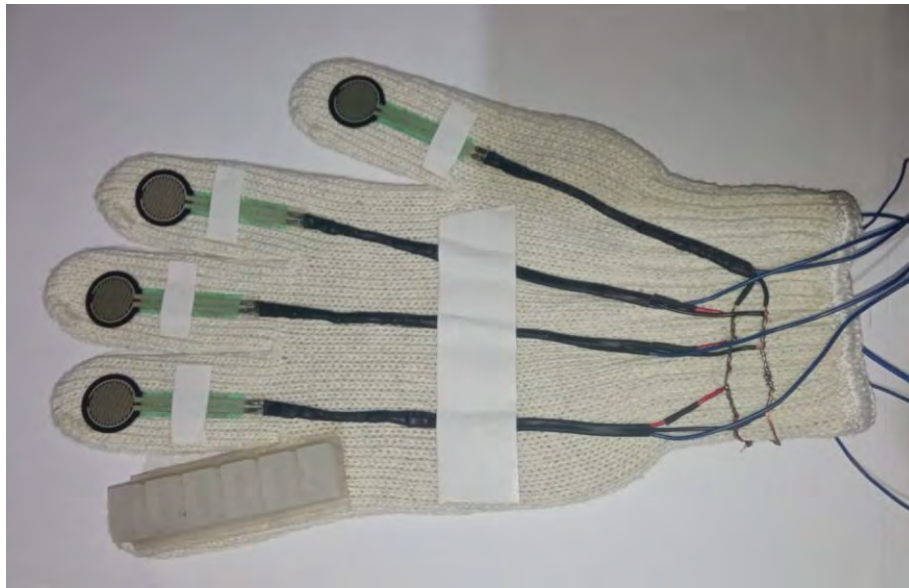
Figura 5.9. Vista superior del guante con los sensores de fuerza y un actuador
