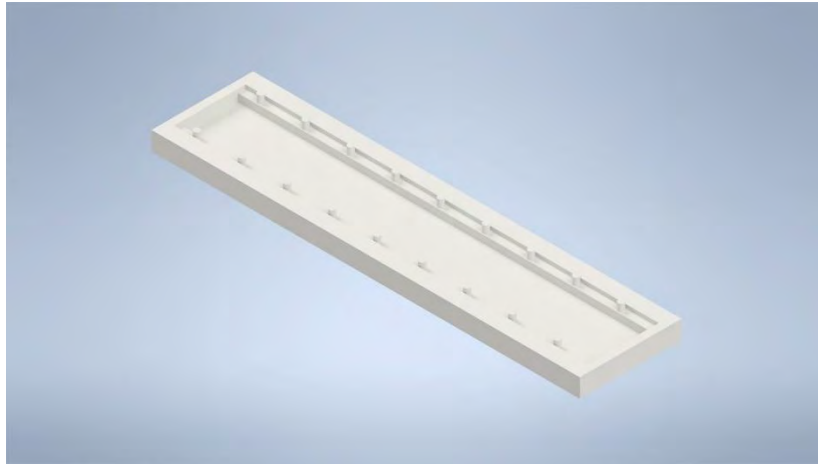
Figura 3.3. Molde para la parte inferior del actuador
