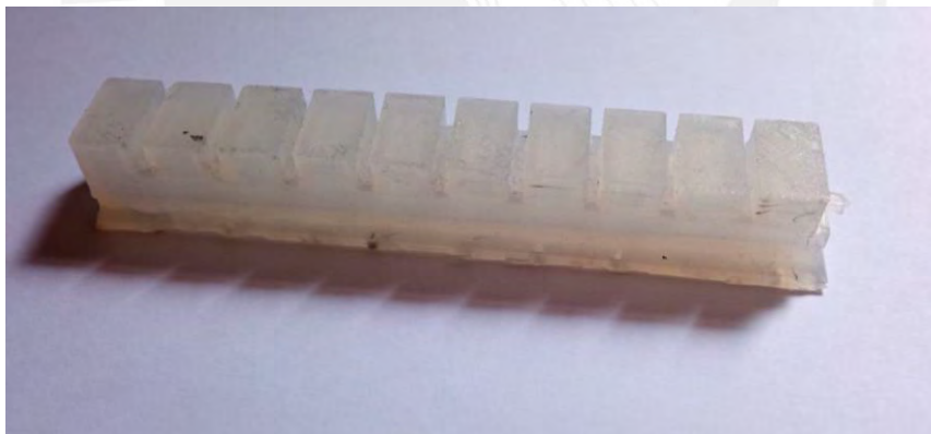
Figura 3.6. Actuador completo después de unir la parte inferior y superior
