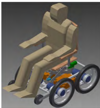
Fig. 2.2 Prototipo de silla de ruedas eléctrica para subir y bajar veredas (López, 2014)
