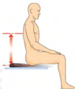
Figura 1.20. Medición de la altura inferior de la escápula para respaldo de la silla.
