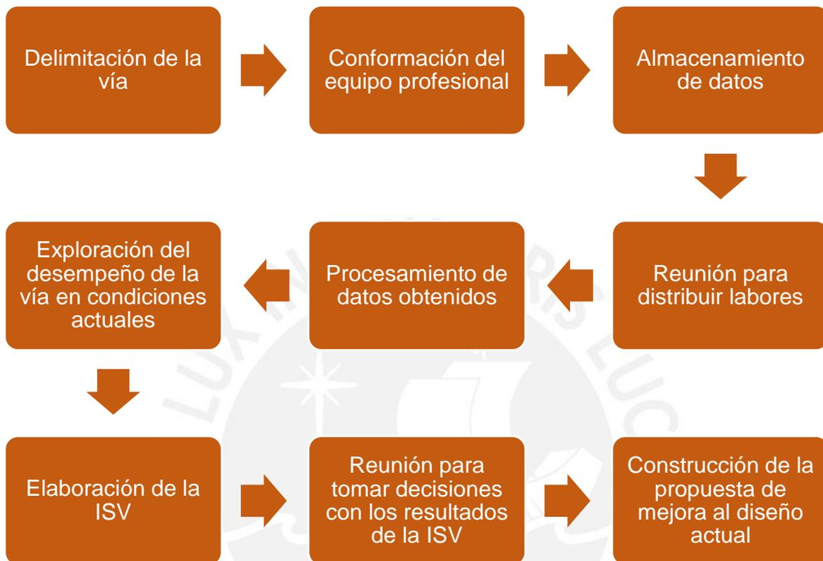
Figura 25. Diagrama de flujo para la elaboración de una Inspección de Seguridad Vial.
