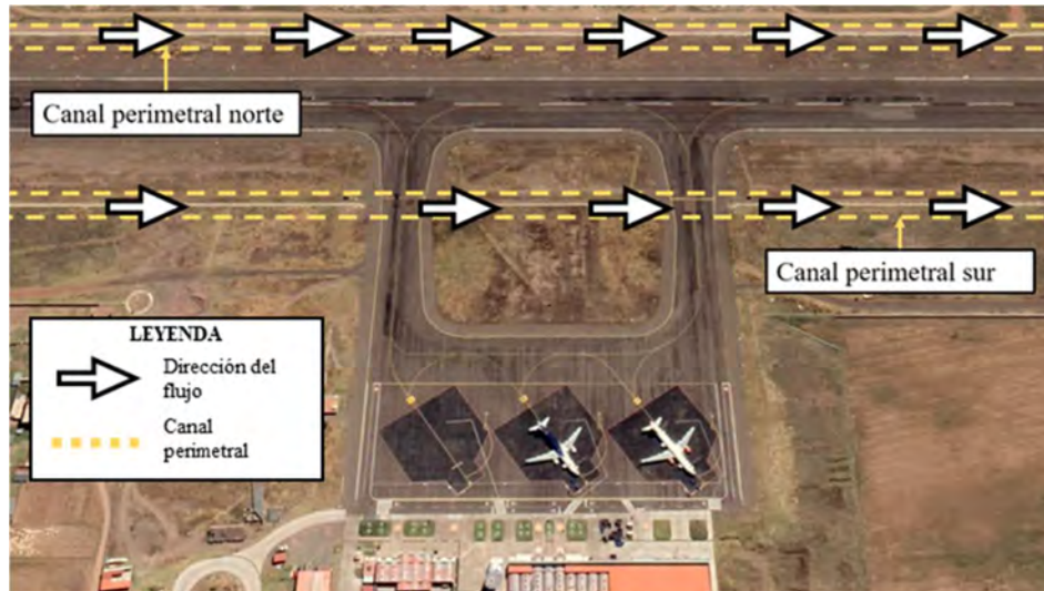
Figura 27. Canal norte y sur existente del aeropuerto.
