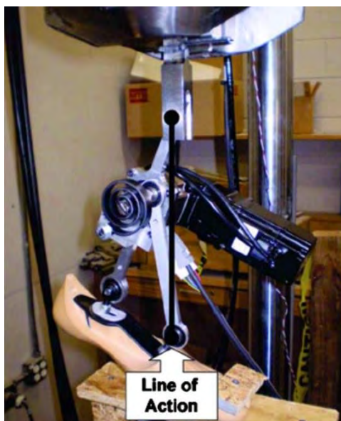
Figura 1.11. Ensayo en prótesis con máquina MTS alterada (Bergelin, 2010)
