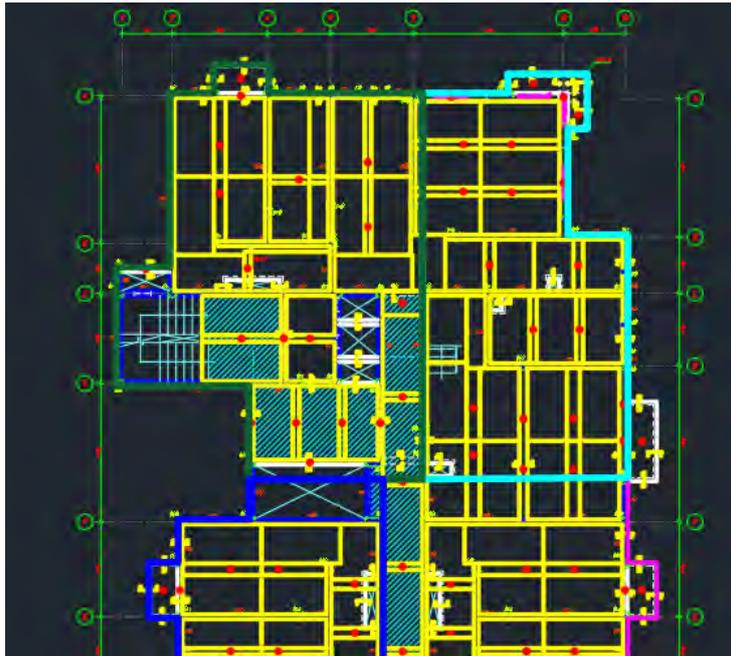
**Figura 33. Modulación de encofrado en Torre C UpTown II. Fuente: Propia.**
