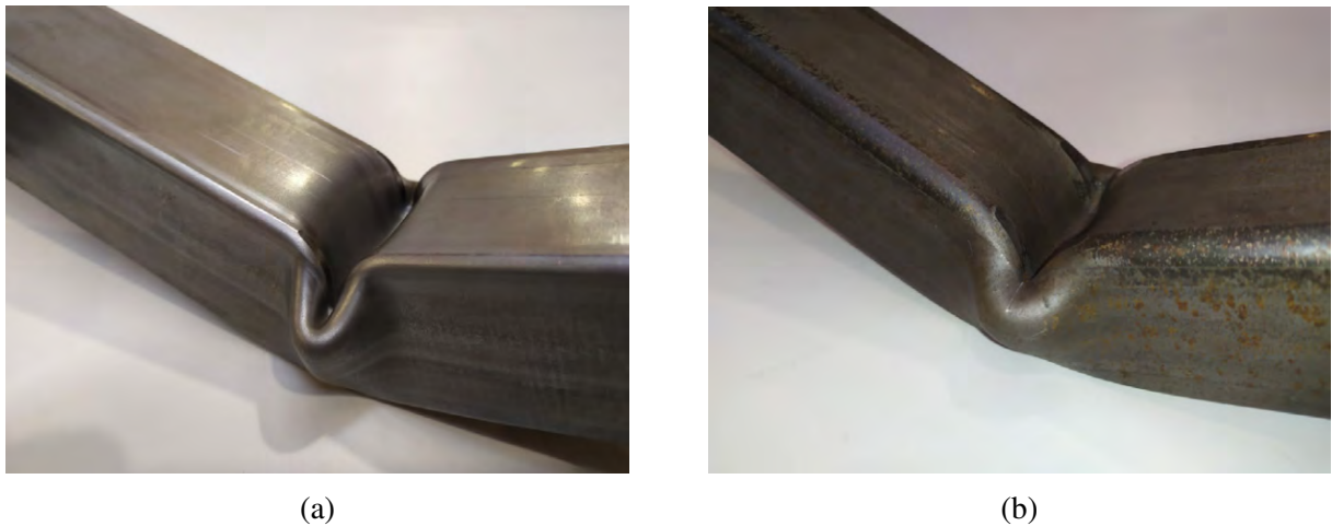
Figura 2.3: Comparación del colapso de un tubo cuadrado con: (a) t/b = 0,04 ; (b) t/b = 0,08 . Imágenes de Lavayen, Boada y Rodríguez (2021).
