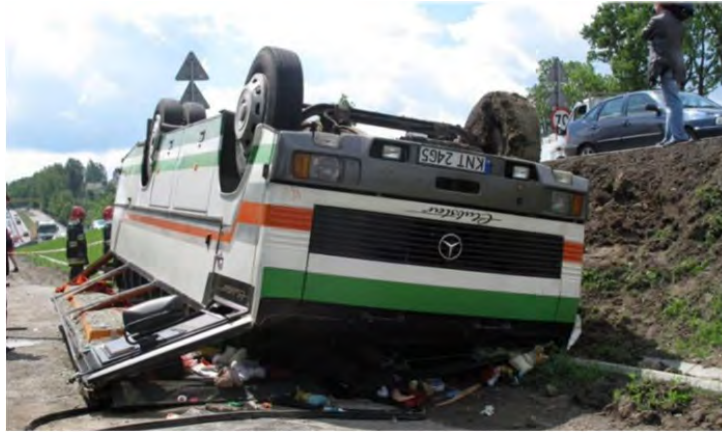
Figura 1.2: Colapso de un autobús por volcadura. Imagen de Karliński y col. (2014).
