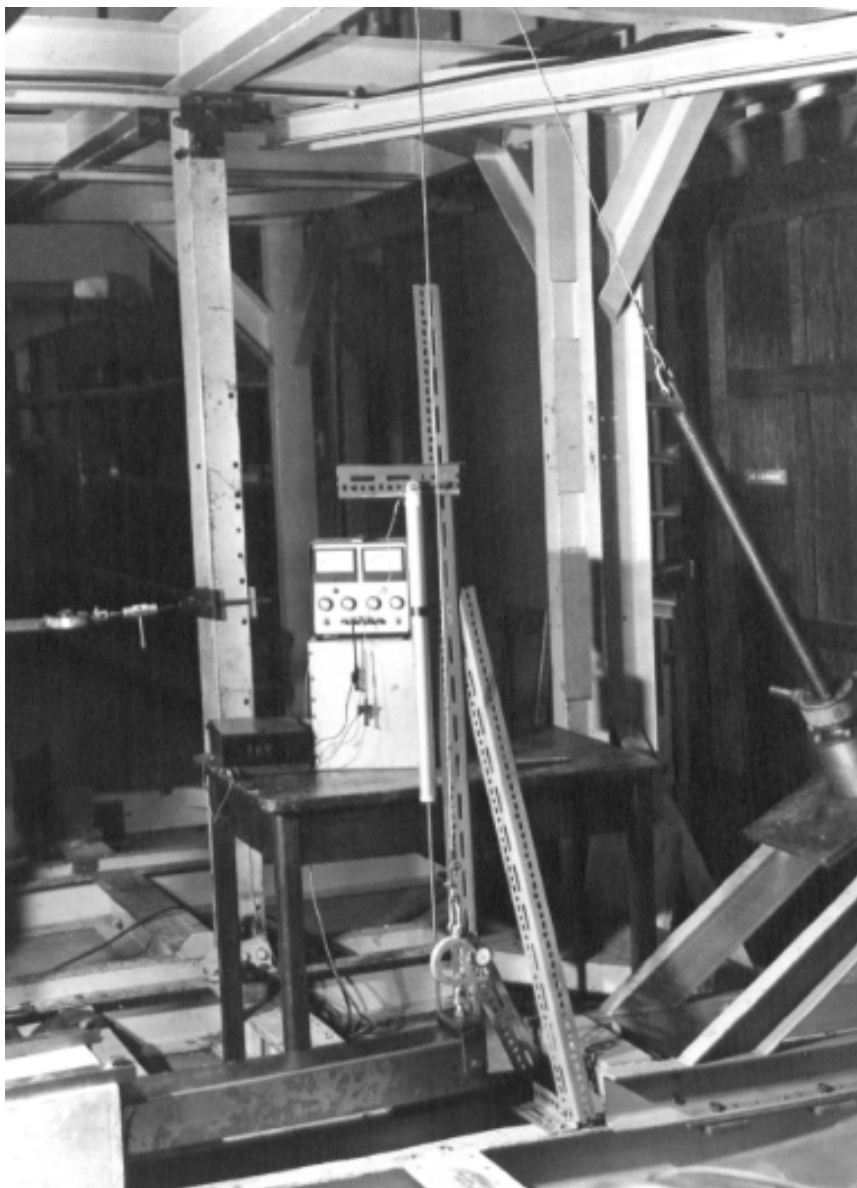
Figura A.2: Máquina completa fabricada por Kecman para realizar el ensayo de flexión de viga en voladizo. Imagen de Kecman (1979).
