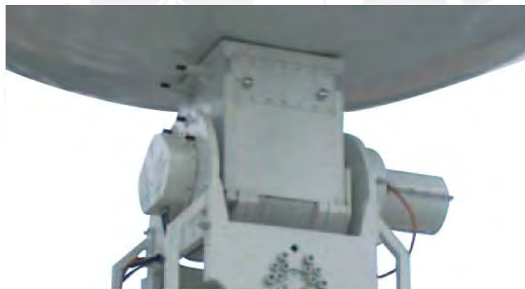
Figura 2-5 Mecanismo de movimiento del posicionador. Cortesía indracompany.com
