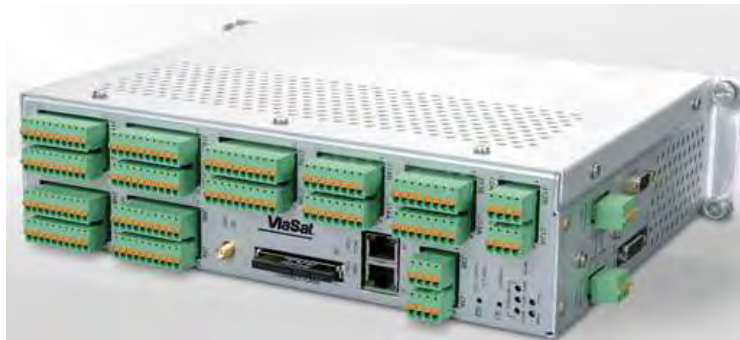
Figura 2-4 Unidad de control de la antena (ACU). https://www.viasat.com
