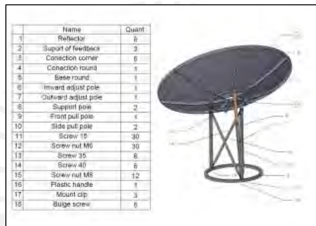
Figura 3-2 Partes mecánicas de la antena original.
