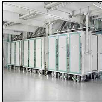
Figura 18. Maquinas de Plansifter (Clasificación de harina)
