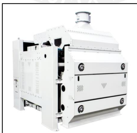
Figura 40. Separador y Limpiador para pre limpieza de trigo
