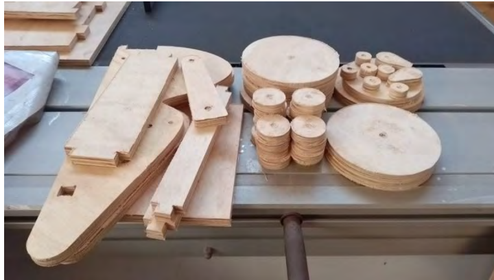
Ilustración 6: Prototipo de Cardadora hecho con Fabricación Digital
