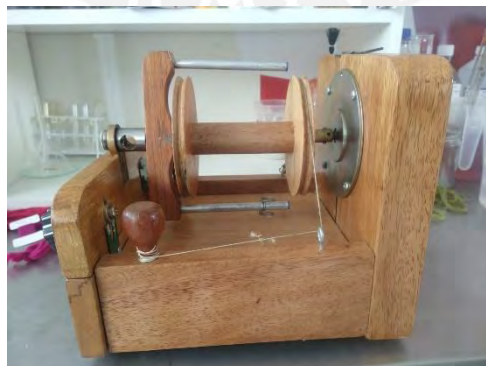
Ilustración 7: Prototipo de Hiladora hecha con Fabricación Digital
