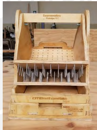
Ilustración 4: Prototipo de Escarmenadora hecho con Fabricación Digital
