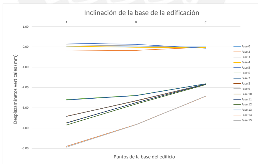
Figura 101. Inclinación de la edificación en las distintas fases
