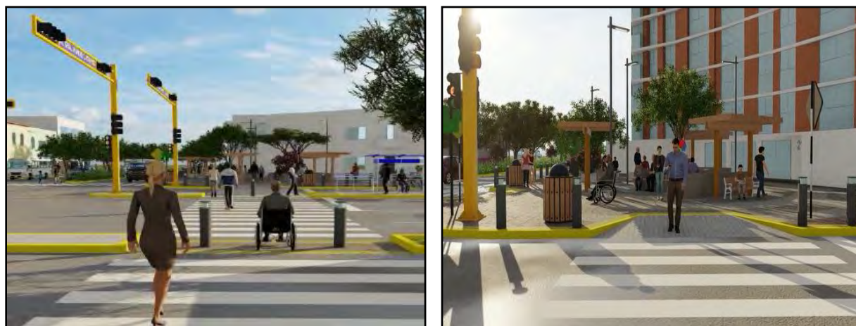
Figura 54. Cruceos a nivel de la calzada y uso de bolardos (Fuente Propia)
