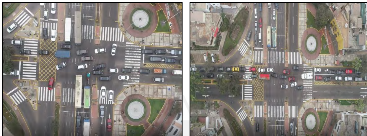
Figura 48. Longitud de cola vehicular (Fuente Propia)
