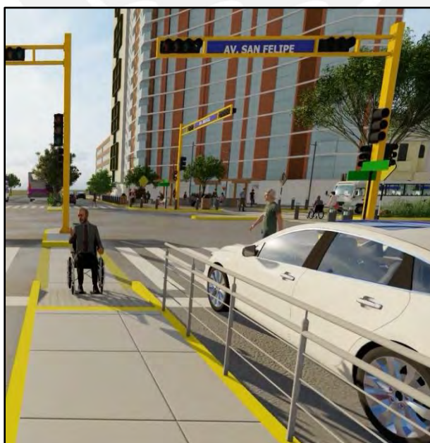
Figura 59. Vallas de seguridad en los paraderos (Fuente Propia)
