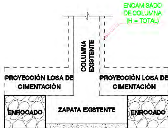
Figura 2.14: Refuerzo de una zapata existente debido a la ejecución de un encamisado de concreto armado
