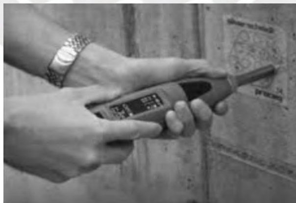
Figura 2.11: Detector de campo magnético y detector de radar utilizados para verificar el acero existente en una columna
