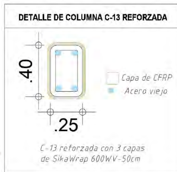
Figura 4.21: Sección de columna C-13 reforzada con CFRP
