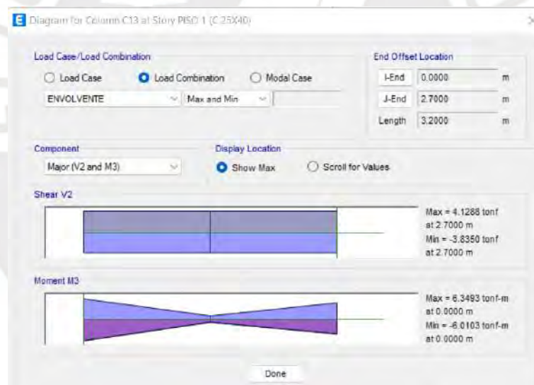
Figura 4.10: Valor de fuerza cortante para la columna C-13 en el primer nivel
