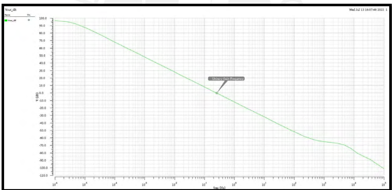
Fig. 63. Respuesta AC de la configuración de integrador
