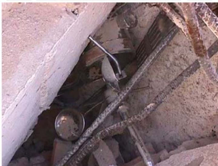
Foto 1 Pararrayos radiactivo entre escombros
