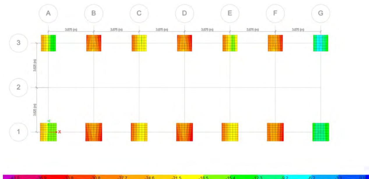
Figura 98. Presiones en la zapata en el sismo Lima 1966.
