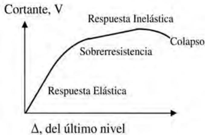
Figura 36. Curva de capacidad. Adaptado de Moreno et al (2009).
