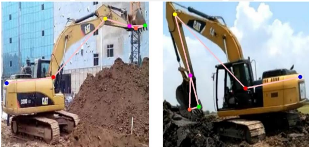
Figura 17. Ejemplos de estimación de las articulaciones de excavadoras.
