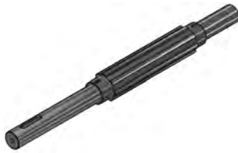
Figura 3.18: Vista isométrica del eje estriado.
