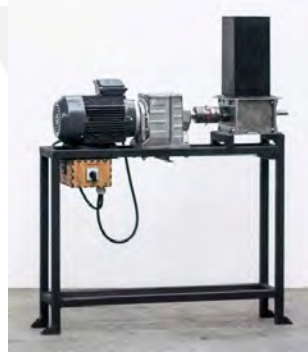
Figura 1.11: Trituradora de Precious Plastic Shredder del diseñador Dake Hakkens.
