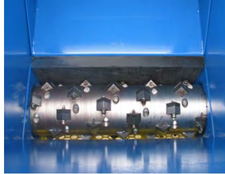
Figura 1.4: Trituradora de 1 rodillo modelo UNI-SHEAR SR300.
