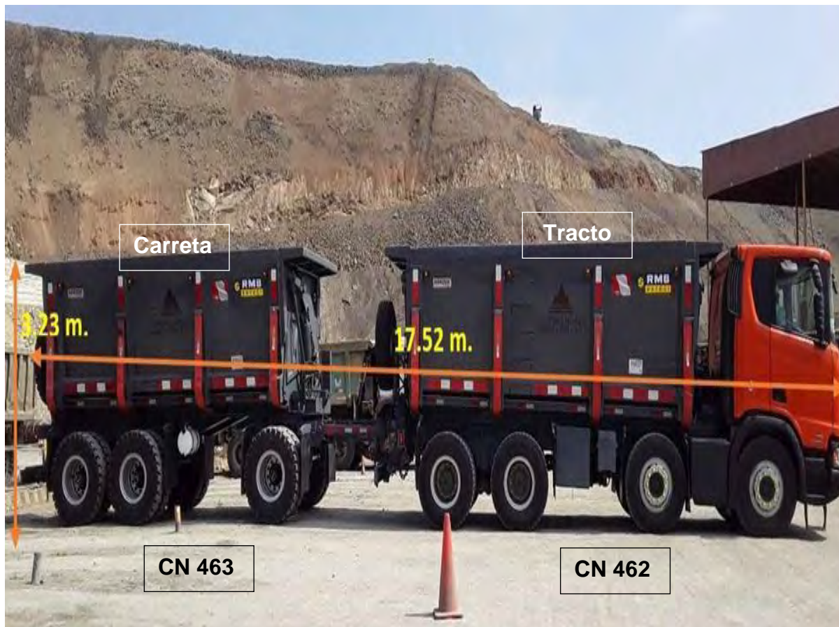
Figura 40. Características técnicas del Volquete Carreta de 80 Ton (Scania)
