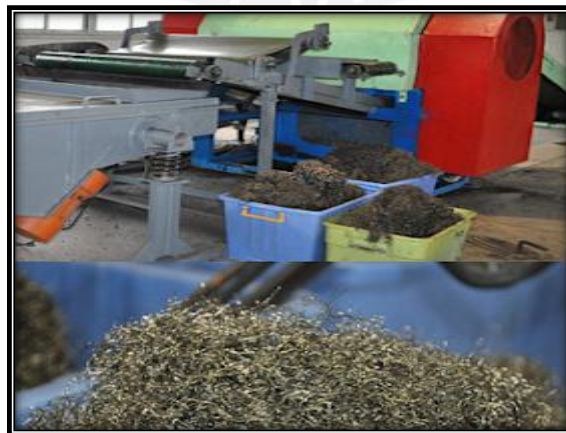
Figura 22. Separación del acero Tomado de “Línea de producción de caucho y polvo”, por Beston (España), 2021.
