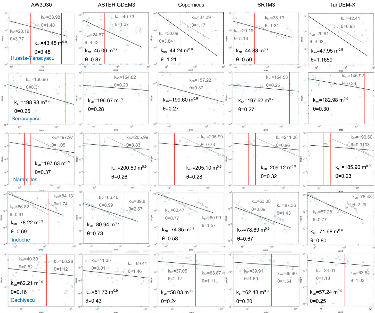
Figura 28. Gráficos gradiente-área de los ríos con knickpoints. La ubicación de los knickpoints se muestra en las líneas rojas. La recta de ajuste e índices geomorfológicos k_{sn} y \theta calculado con el método gradiente-área se muestran en negro para el río completo en negro y en gris para cada segmento, excluyendo los segmentos cortos donde la baja cantidad de bins no permite la representatividad de los resultados.
