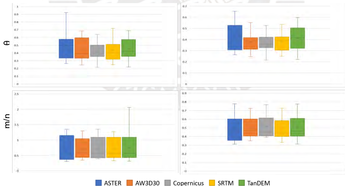
Figura 25. Box plots de los índices de concavidad de las subcuencas mediante el método gradiente-área (arriba) y método integral (abajo), considerándose las cuencas aluviales (izquierda) y descartándose (derecha).
