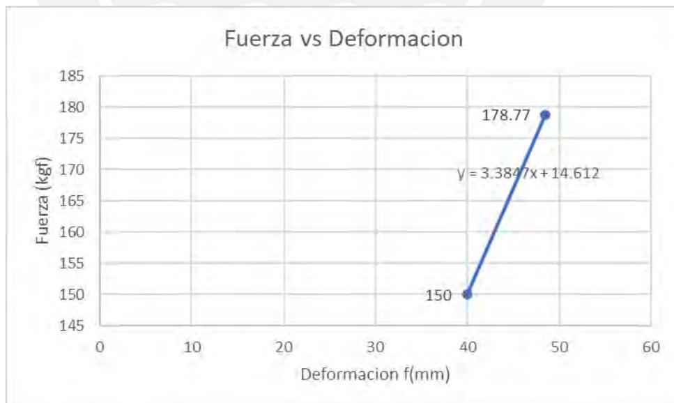
Figura 40 Gráfica de Fuerza vs Deformación del resorte
