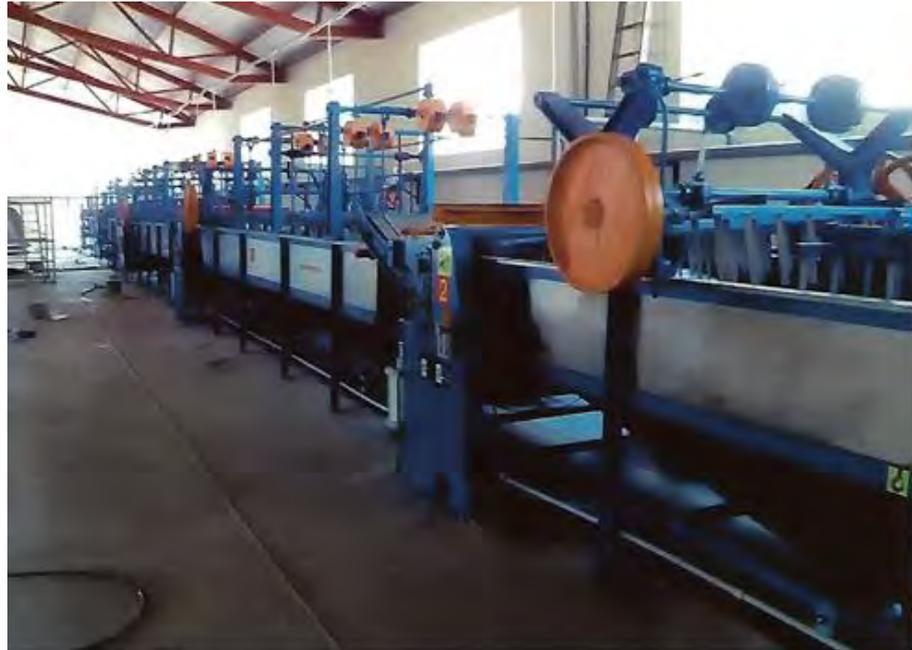
Figura 7 Sistema de Lavado de Lana
