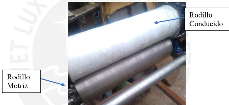
Figura 52 Montaje de Rodillos Exprimidores
