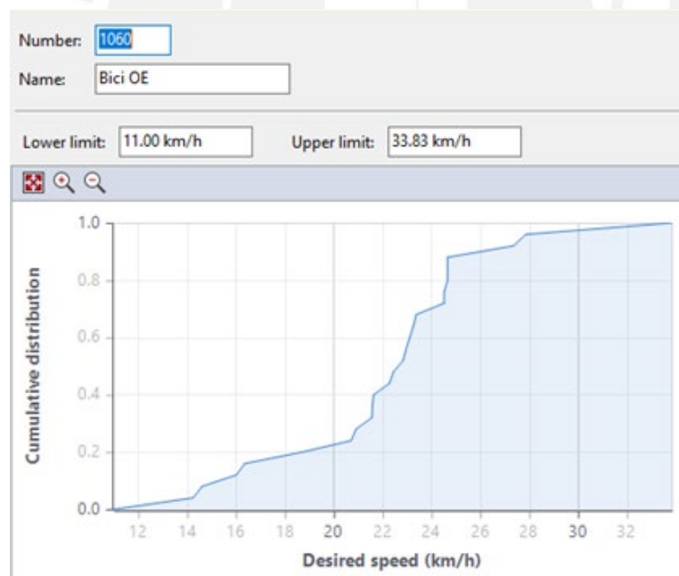
Figura C30. Distribución de frecuencias para velocidad (bicicletas) – Validación – Av. Benavides (Oeste a este)
