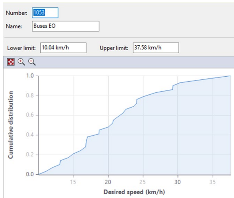
Figura C23. Distribución de frecuencias para velocidad (buses) – Validación – Av. Benavides (Este a oeste)
