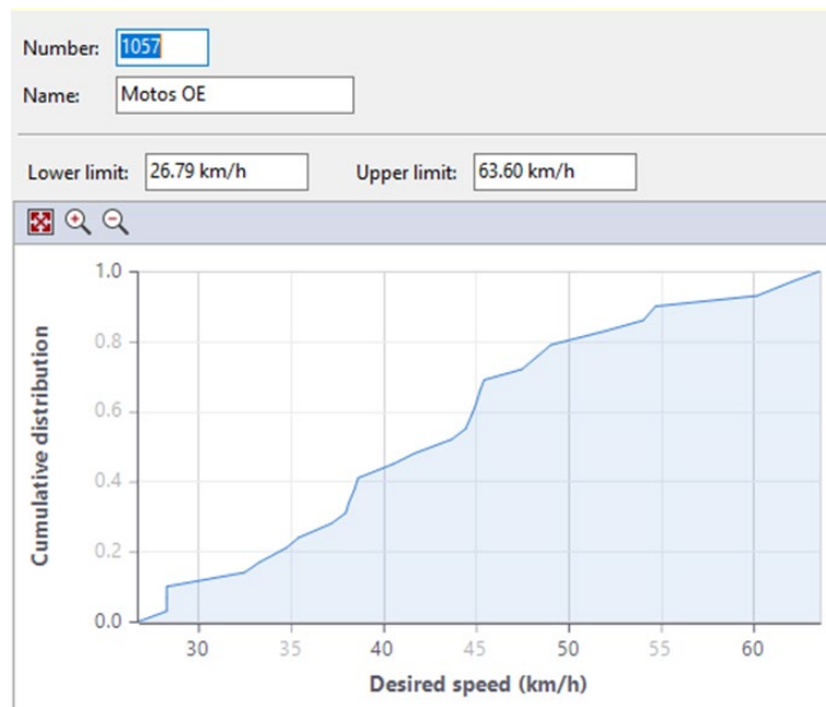
Figura C27. Distribución de frecuencias para velocidad (motos) – Validación – Av. Benavides (Oeste a este)
