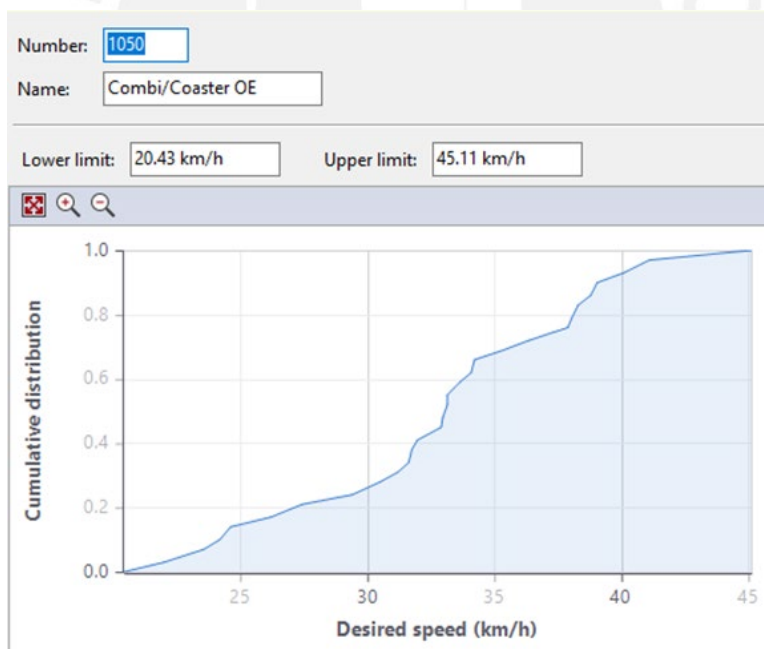
Figura C20. Distribución de frecuencias para velocidad (combi/coaster) – Validación – Av. Benavides (Oeste a este)
