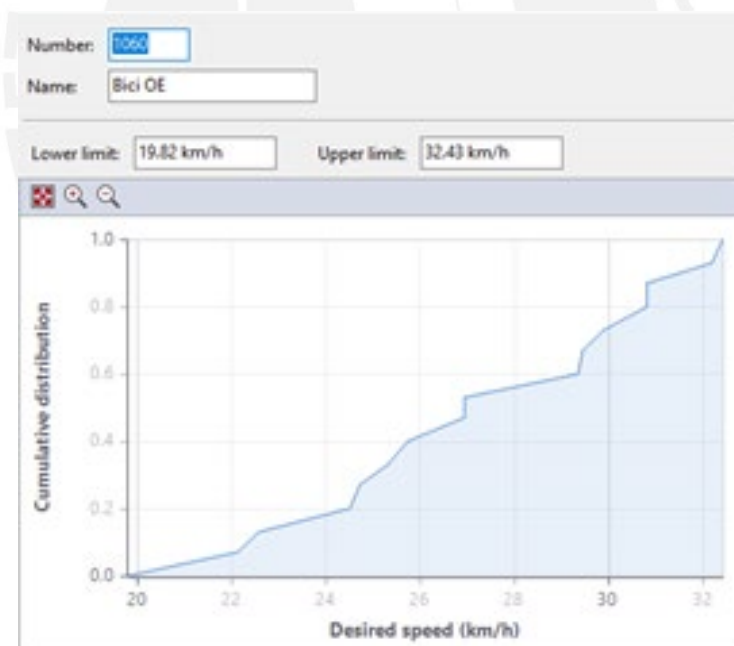
Figura C14. Distribución de frecuencias para velocidad (bicicletas) – Calibración – Av. Benavides (Oeste a este)
