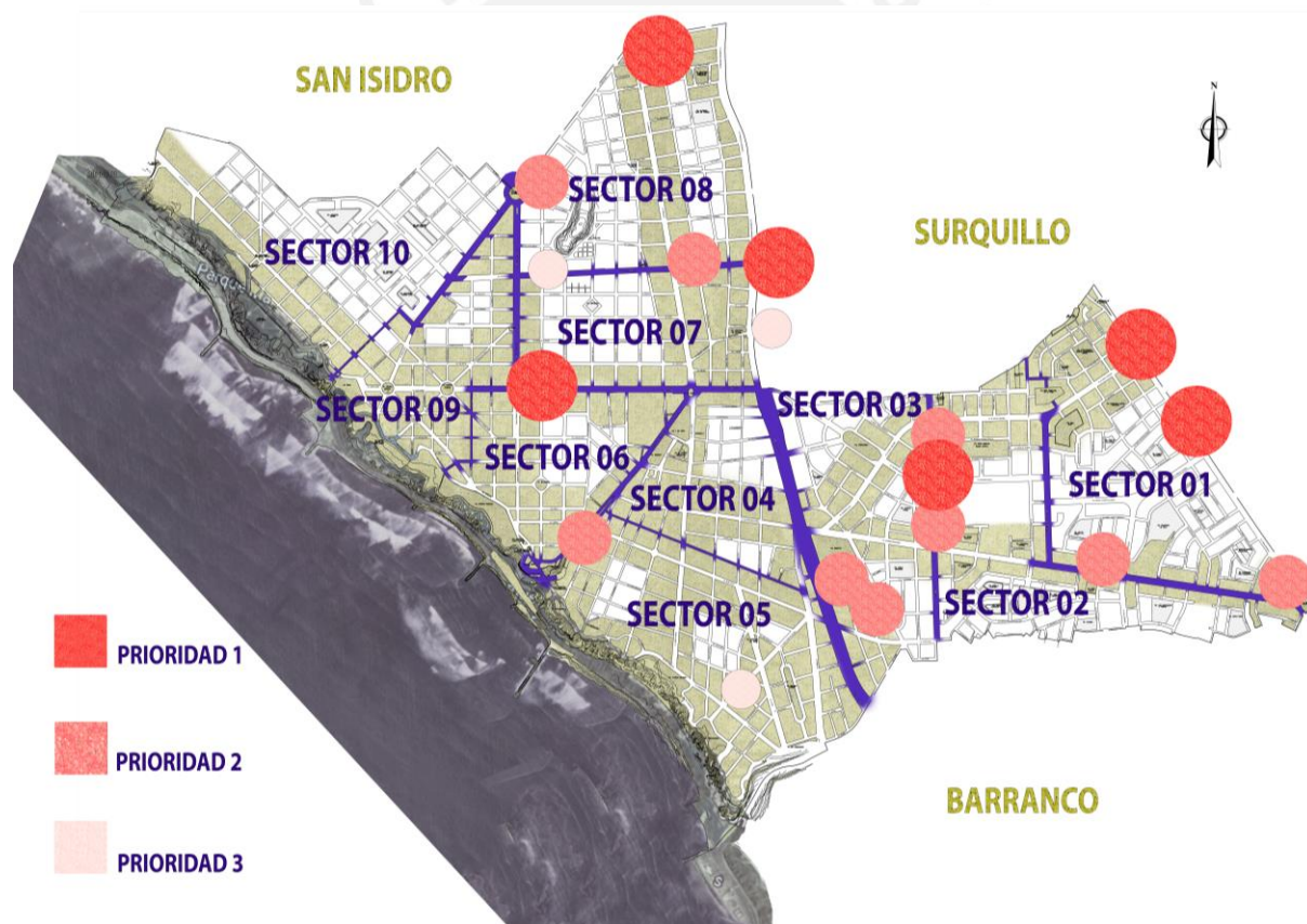
Figura 17. Niveles de prioridad en el distrito con respecto a las demoras y a los niveles de servicio en las diferentes intersecciones (Fuente Propia)
