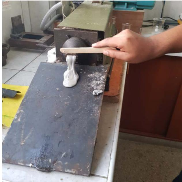
Prueba 2: Evaluación de las condiciones y parámetros operativos de trabajo para una mezcla de resina plástica HDPE virgen y HDPE reciclado y picado, en una proporción de 50%-50% en volumen.
