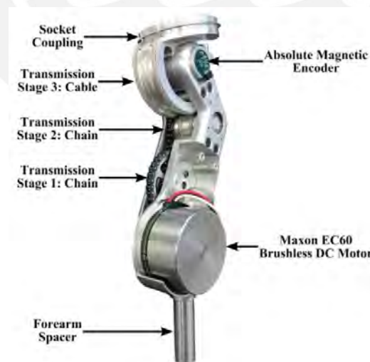
Figura 2.16 Prótesis transhumeral mioeléctrica desarrollada por Bennett et al 23
