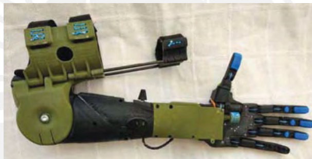
Figura 2.17 Prótesis transhumeral con soporte supernumerario 24
