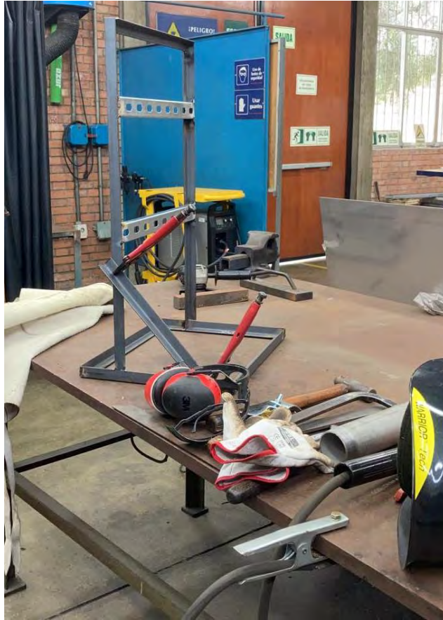
Figura 1: Proceso de construcción del soporte: Sobre la mesa de trabajo, de derecha a izquierda se observa: casco de soldar, toma de tierra y porta electrodo, EPPs y herramientas varias y soporte durante el proceso constructivo
