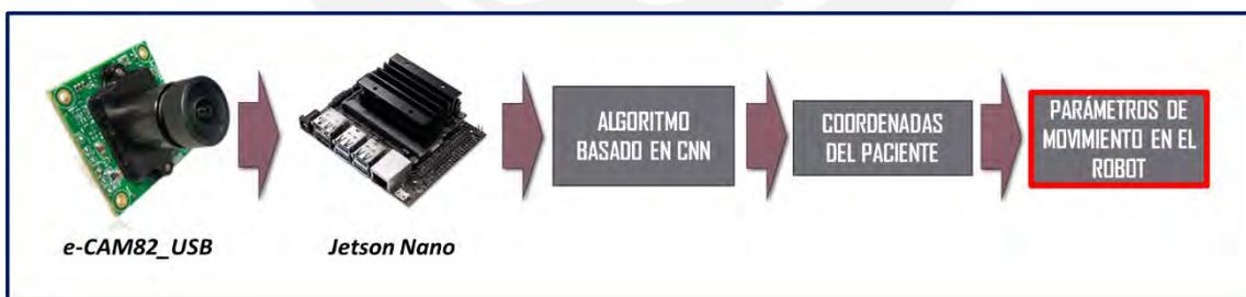
Figura 2.7: Diagrama de bloques del modelo de solución.
