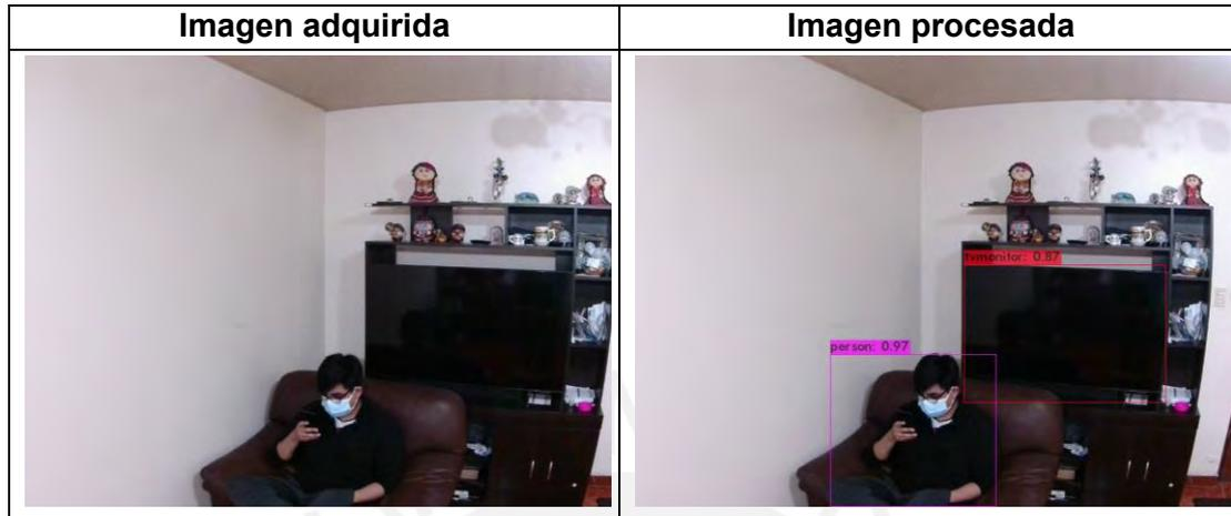
Entonces, se genera otro archivo **“\*.json”** con la descripción, entradas y salida generadas después de la aplicación en modelos entrenados, de los resultados obtenidos se interpreta la siguiente descripción: **“El robot no debe rotar pero sí avanzar hacia adelante porque se encuentra a 2 metros de distancia”**, luego de un periodo se extrae la siguiente imagen y se repite la operación anterior.
