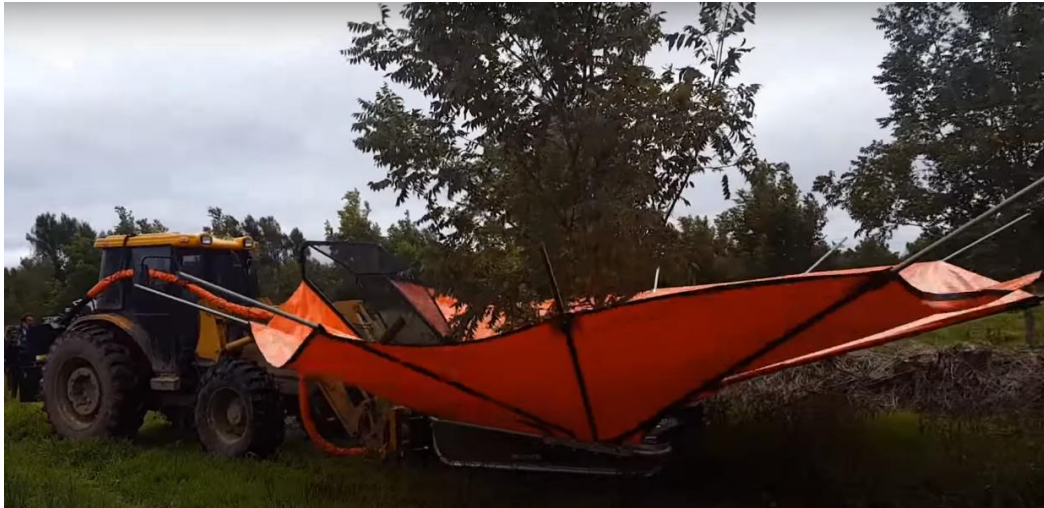
Figura 35. Cosechador de pecana jalada por un tractor. Tomado de “ Metalúrgica LF diseñó una pala especial para recolectar nuez pecán ” Maquinac, 2018. ( https://maquinac.com/2018/07/metalurgica-lf-diseno-una-pala-especial-para-recolectar-nuez-pecan/ )
