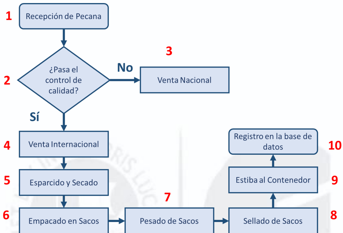
Figura 5. Diagrama de flujo del empaqueo de la pecana de exportación. Tomado de “Base de Datos de Emporium Import Export S.A.C.”. 2020.
