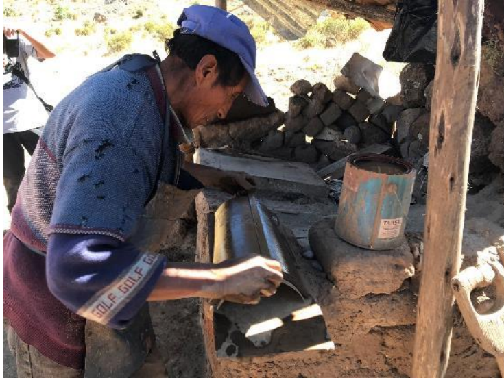
Fig. 49 Elaboración de maestro de tejas de arcilla con molde en Aucará (Fuente propia 2019)
