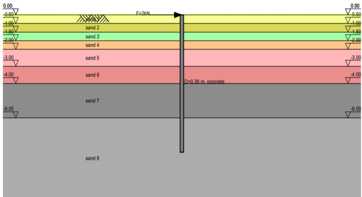
Figura 29 Distribución de capas en el programa D-Sheet Piling
