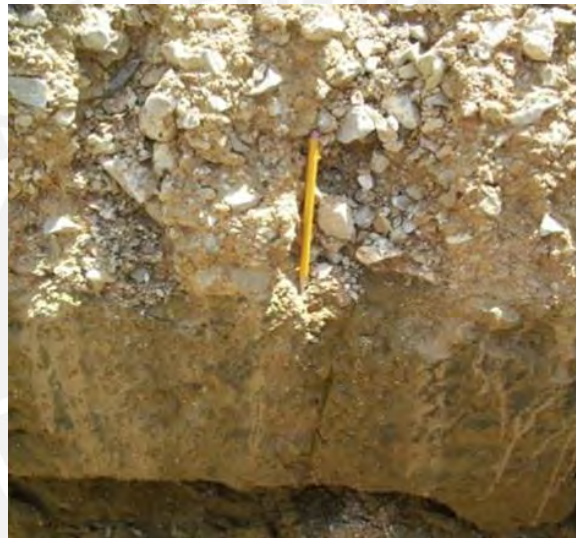
Figura 10: Arcilla con consistencia granular luego de una estabilización con cal (Castañeda 2019)
