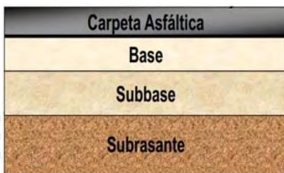
Figura 2: Estructura típica de un pavimento flexible (Ortiz, 2017)
