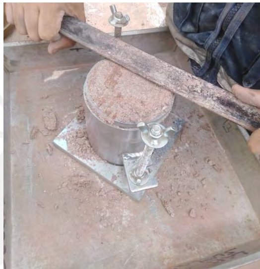
Figura 19: Fabricación de muestras para el ensayo Proctor estándar
