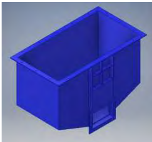
Figura 3.2. Estructura de la tolva de alimentación.
