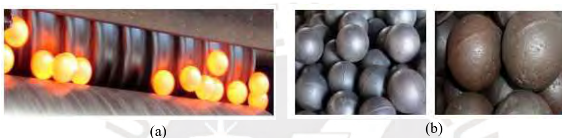
Figura 1.1. a) Bolas de acero laminado y b) Bolas de acero fundido. (Mepsa,2018)
