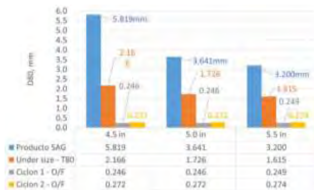
Figura 1.6. Resumen de pruebas variando el diámetro de las bolas del Molino SAG. (Compañía Minera Antapaccay, Enero 2018)
