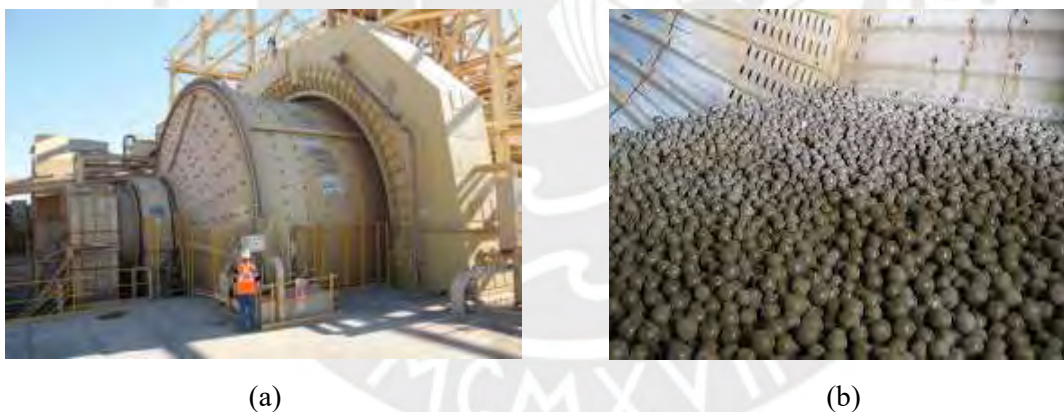
Figura 1.3. (a) Molino SAG visto desde el exterior y (b) visto desde el interior con el llenado de bolas. (Flsmidth, 2012)
