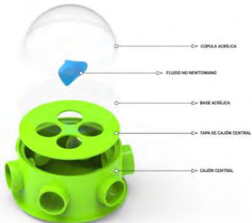
Partes de la estructura central del juego multisensorial drums
