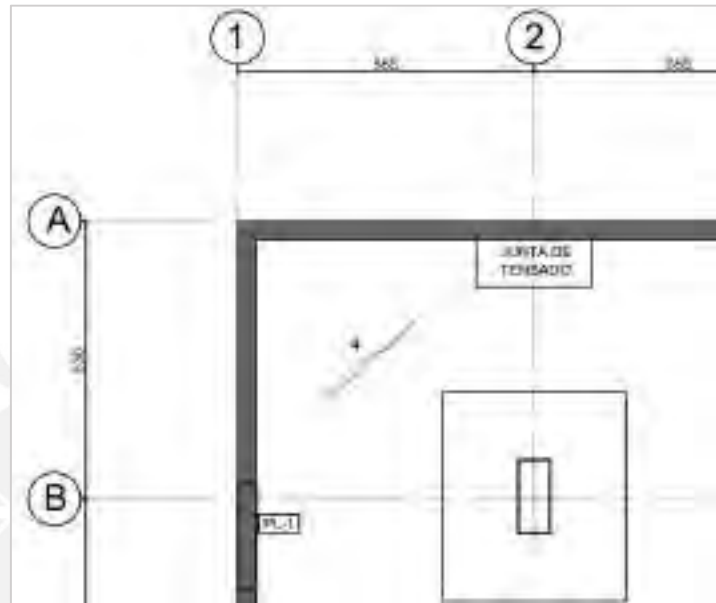
Figura 5.4: Fisura 4 ubicada en la esquina superior izquierda del piso en el sótano 5
