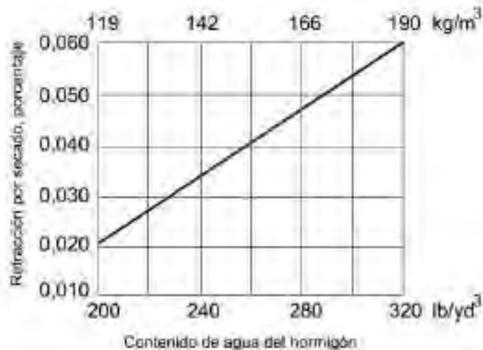
Figura 3.10 Efecto típico del contenido de agua del concreto sobre la retracción por secado (fuente: USBR, 1981)
