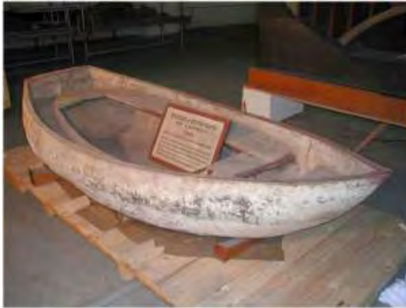
Figura 2.2 Primera barca de concreto armado
