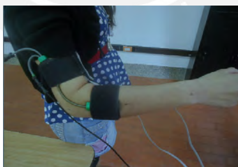
Figura 1.15 Electrogoniómetro basado en IMU's y goniómetro modelo SG110 usados para medir el ángulo de flexión-extensión. (Ruiz, 2017)
