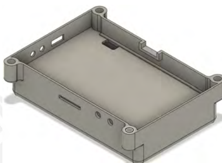
Figura 4.10 Base de la caja electrónica (vista superior)
