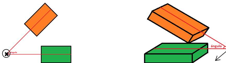
Figura 6.21 Medición de ángulo respecto del eje vertical (izquierda) y eje transversal (derecha)
