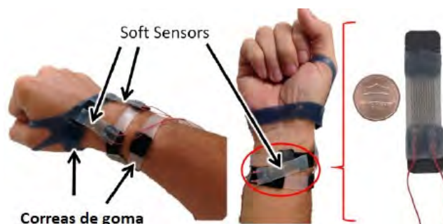
Figura 1.14 Prototipo de goniómetro con 3 soft sensors (Vogt, 2014)
