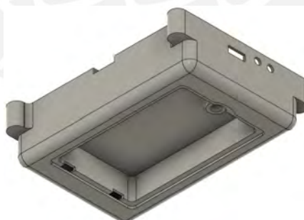
Figura 4.11 Base de la caja electrónica (vista inferior)
