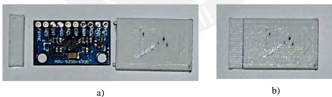
Figura 6.19 Caja del sensor fabricada: a) desensamblada y b) ensamblada
