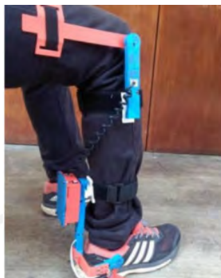
Figura 1.16 Prototipo del electrogoniómetro WHITE (Israel, 2017)
