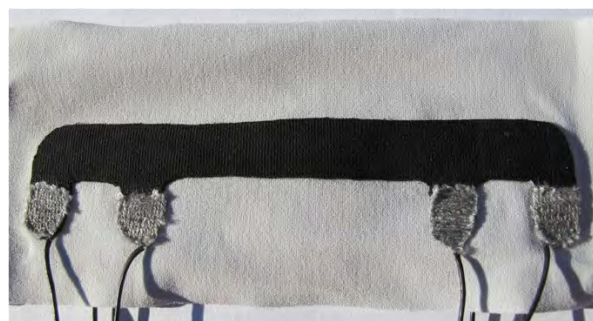
Ilustración 10. Detalle de una capa de un KPF sensor de doble capa centrada en la conexión entre sensores y cables conductores. (Togneti, 2014)
