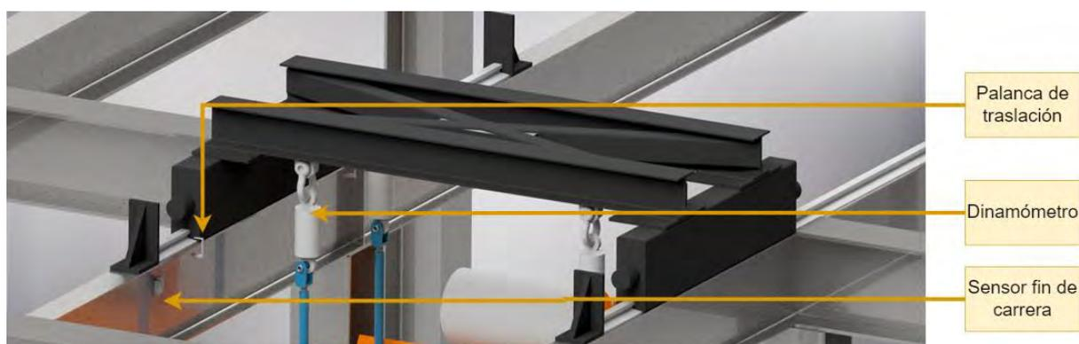
*Figura 79 Sistema de traslación
