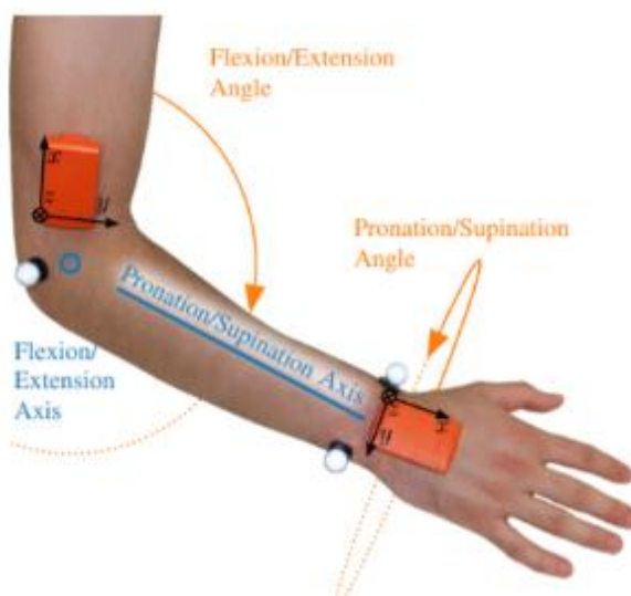
Fig. 1.10 Medición de ángulos del codo con solo dos IMU's [Müller, 2016]
