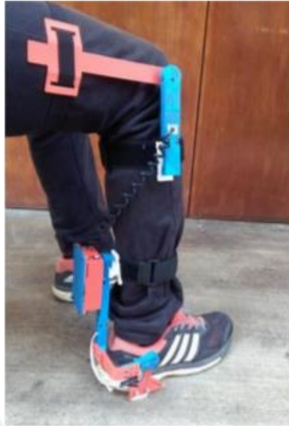
Fig. 1.13. Electrogoniómetro para tobillo y rodilla por impresión 3D [Luis, 2017]
