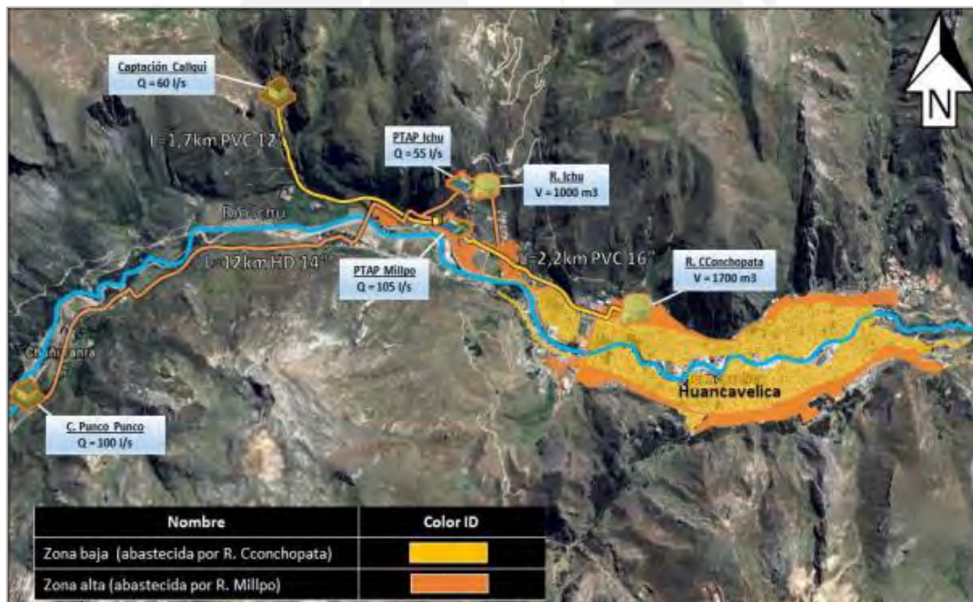
Figura 10. Esquema general del sistema de agua potable suministrado por la empresa prestadora de servicios en la ciudad de Huancavelica.
