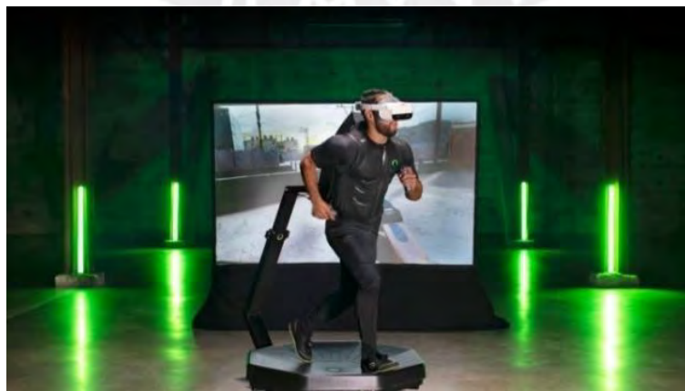
Figura 43: Dispositivo Omni One que permite correr en realidad virtual sin movernos del sitio (Fuente: Raya, 2020)
