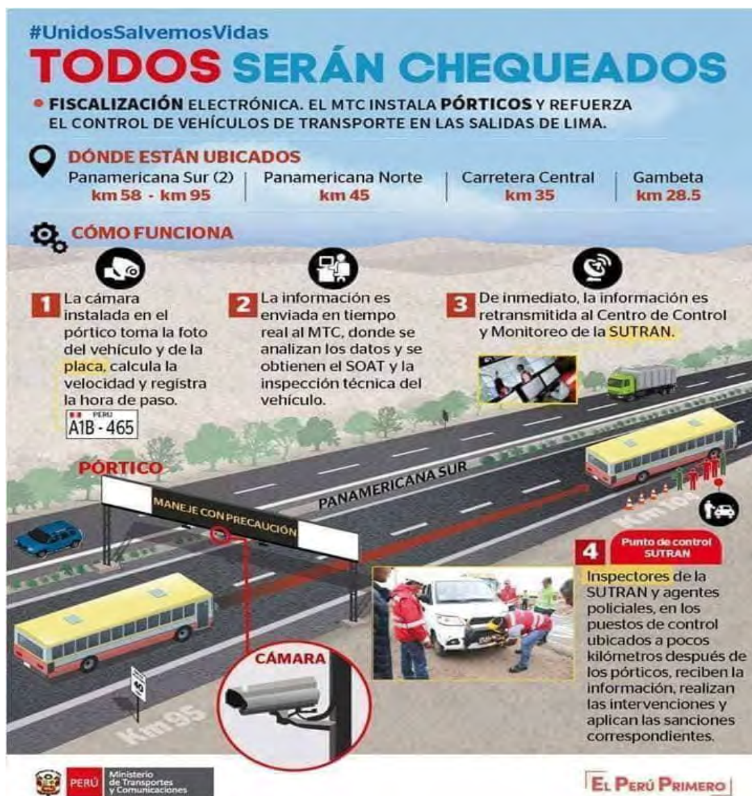
Figura 13. Infografía del proceso de fiscalización electrónica realizada por los pórticos. Nota: Ministerio de Transportes y Comunicaciones [MTC] (2018).
