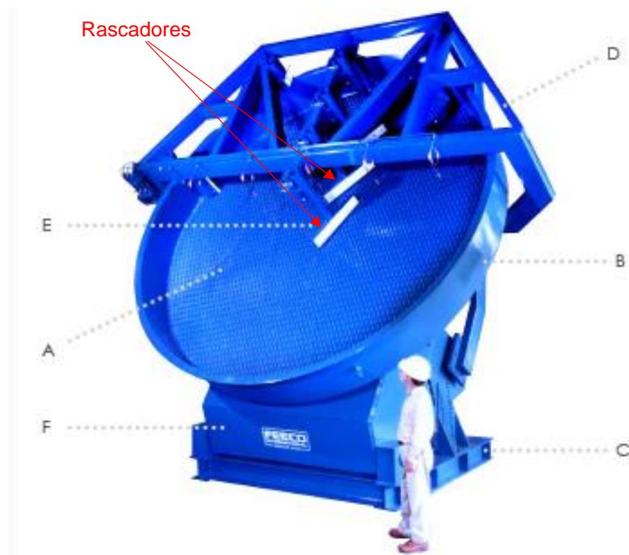
Figura 17. Disco granulador típico
