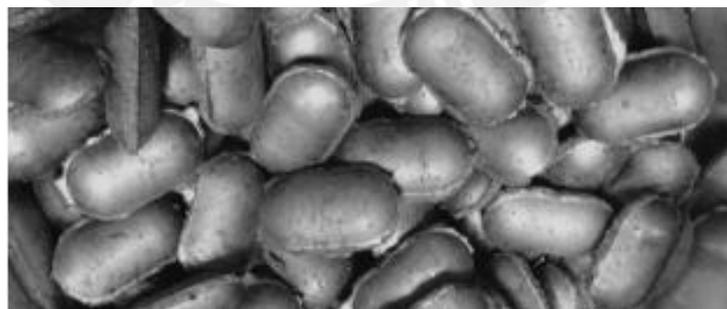
Figura 6. Briquetas de carbón y desechos de hierro
