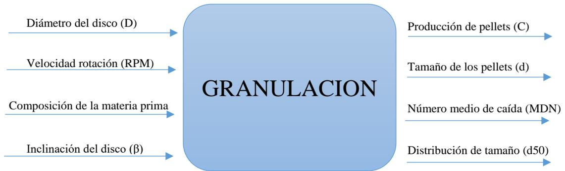
Figura 8. Diagrama de caja negra para el proceso de granulación
