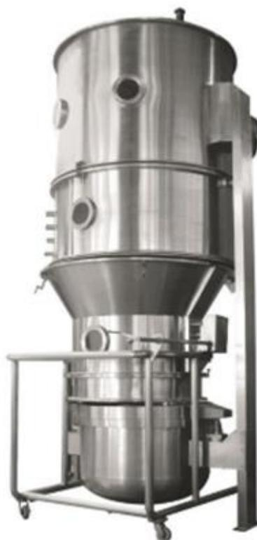
Figura 4. Granulador de lecho fluidizado
