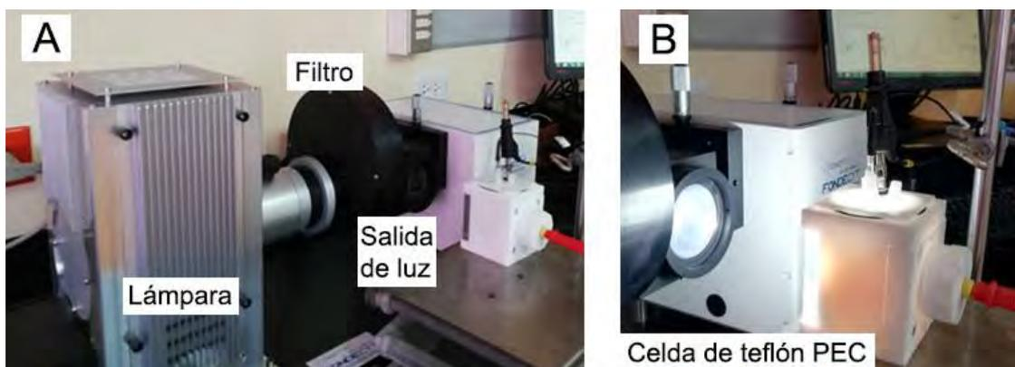
**Figura 37.** Arreglo experimental para la realización de los ensayos LSV y cronoamperometría. (A) Vista general del simulador solar compuesto de una lámpara, un filtro y la salida de luz y (B) la celda fotoelectroquímica de teflón con tres electrodos iluminada durante los ensayos.
