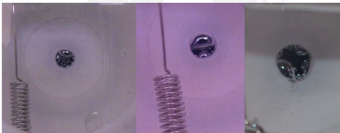
**Figura 64.** Tomas fotográficas del electrodo de trabajo p-Si (100) durante la formación de burbujas de hidrógeno durante los ensayos de cronoamperometría en H<sub>2</sub>SO<sub>4</sub> 1M.
