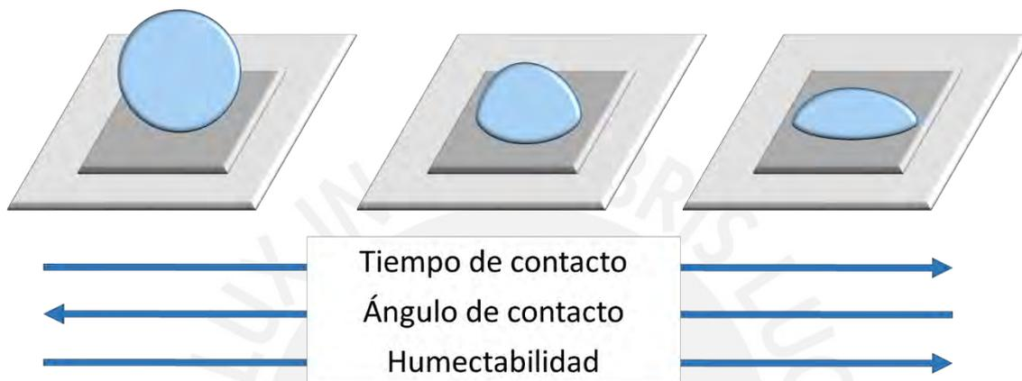
**Figura 67.** Representación esquemática de humectabilidad de la superficie del electrodo de p-Si (100) con el paso del tiempo durante el ensayo de cronoamperometría.
