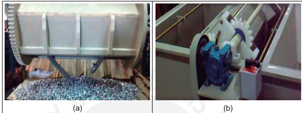
Figura 2.4. Tambor utilizado en la industria para cincado electrolítico. a) Vista frontal del tambor rotativo. b) Motor AC y sistema de transmisión de potencia. Fuente: Propia.
