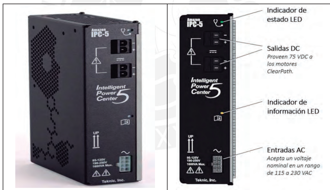
Figura 4.24 Fuente de alimentación DC IPC-5. Fuente: teknic.com
