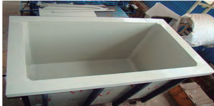
Figura 1.2 Tanque de polipropileno para cincado electrolítico. Fuente: indiamart.com
