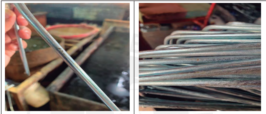
Figura 1.7 Piezas con errores en su proceso de cincado. Fuente: Propia
