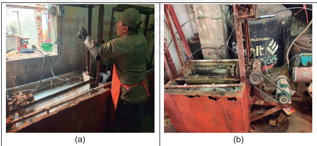
Figura 1.6 Cincado electrolítico en las pequeñas y medianas empresas. a) Operario cincando manualmente. b) Sistema para cincado manual. Fuente: Propia
