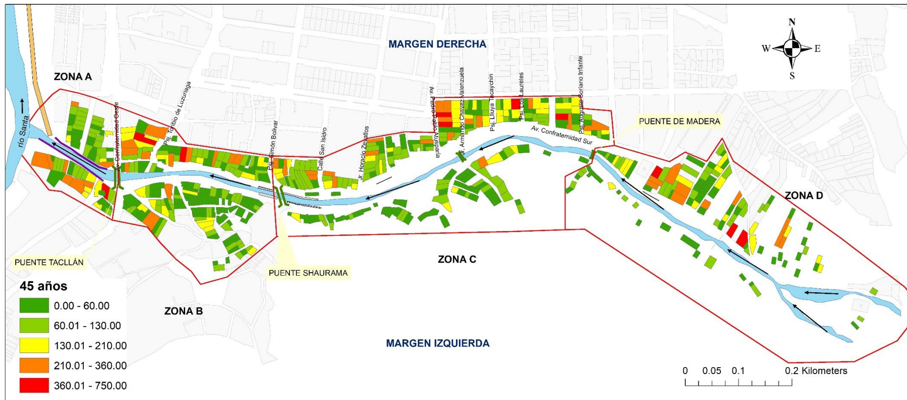
Figura 7.18. Distribución espacial de las pérdidas de materiales en las edificaciones de la zona del río Seco de Huaraz. Escenario 45 años (Toneladas)
