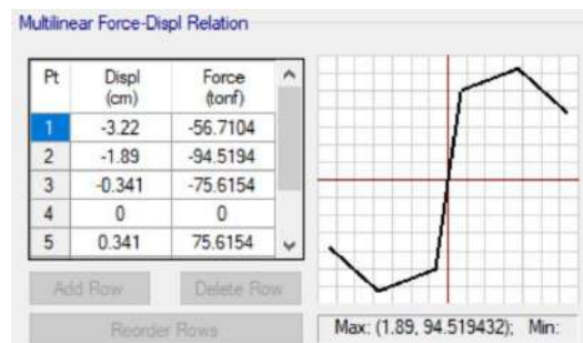
Figura B1: Curva Cortante-Desplazamiento del elemento Link que representa a los muros de albañilería del Pabellón A.
