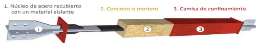
Figura 33: Configuración de las barras de pandeo restringido.
