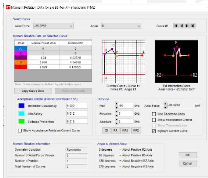
Figura A9: Introducción de los parámetros de la rótula de la columna seleccionada
