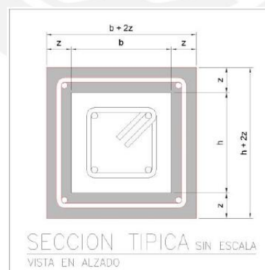
Figura 72: Reforzamiento de una columna por medio de anillos perimetrales
